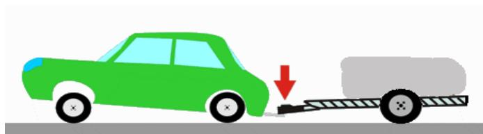
A su vez el tren delantero se verá notablemente influenciado por el levantamiento de la carrocería, provocando que las ruedas motrices (si el vehículo tiene tracción delantera) no traccionen correctamente, el sistema de dirección pierda tenida en los virajes y se vea comprometida la eficiencia de los frenos delanteros.
