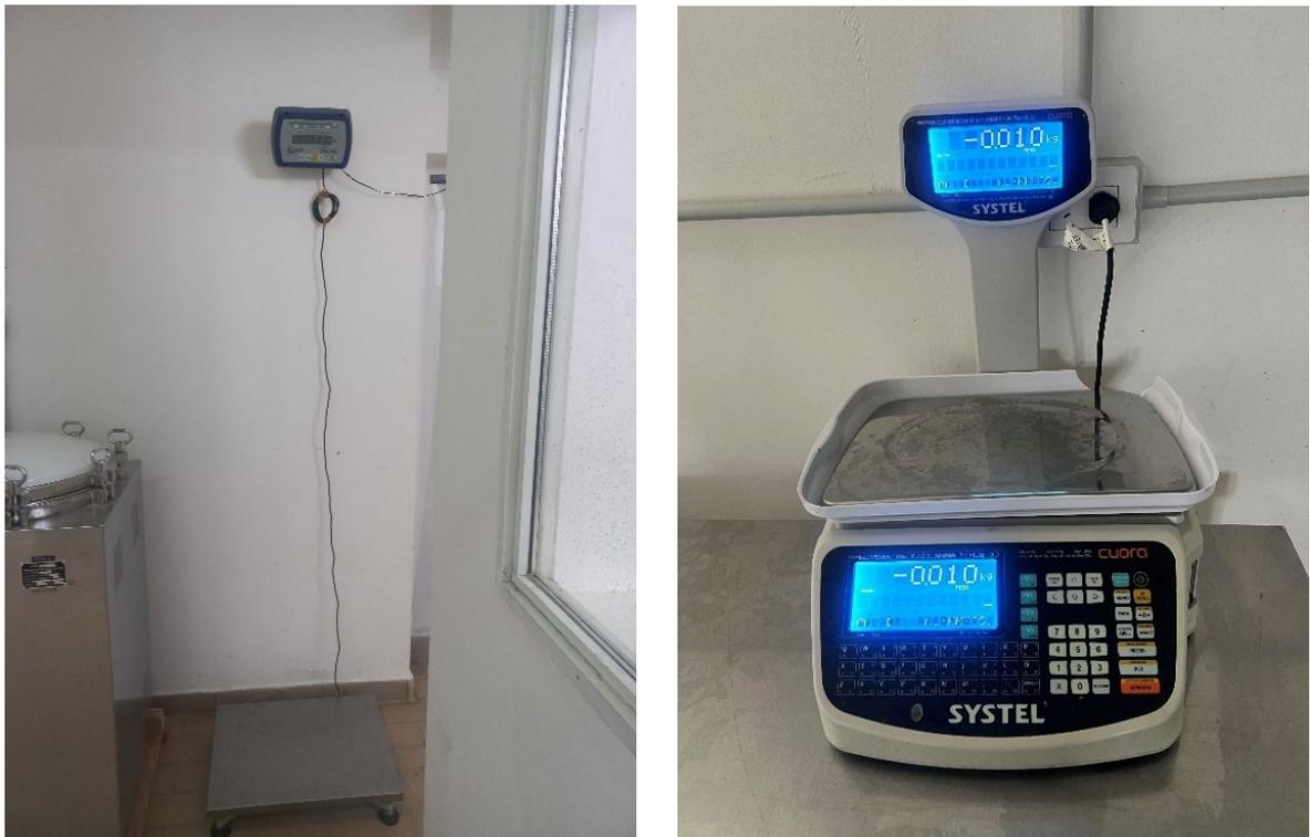
*Figura 11. Balanza SYSTEL Nexa 300 para pesaje de materia prima (izq.) y SYSTEL Cuora 30CM para pesaje de producto procesado (der.).*
