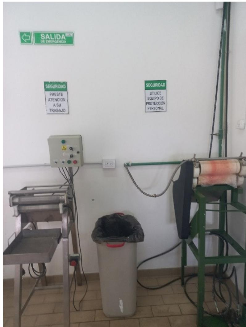
Figura 10. Máquinas pelapatas.
