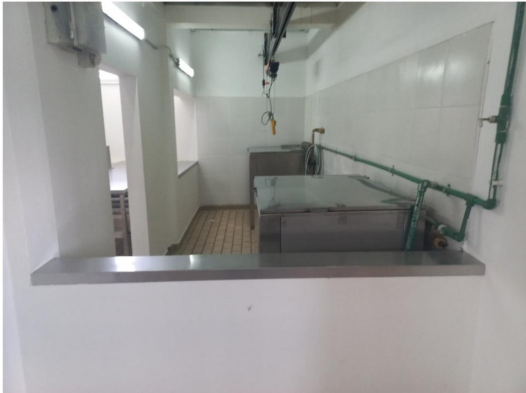
*Figura 7. Ollas de cocción (al fondo) y de enfriamiento (al frente).*
