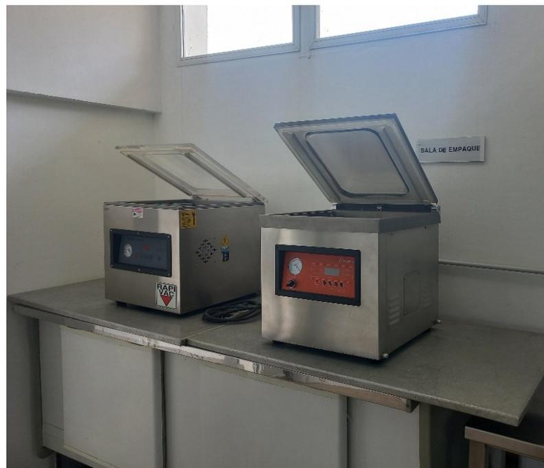
Figura 9. Envasadoras al vacío (izq: RAPIVAC DZ-400, der: BRUNETTI VT-40).
